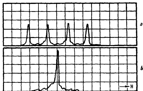
Fig. 4. Protonenresonanzspektrum von \text{BH}_4^+ -Ionen. — a) Ohne gleichzeitige Anregung der \text{B}^{11} -(Spin 3/2)-Resonanz. — b) Bei gleichzeitiger Anregung der \text{B}^{11} -Resonanz. Die an den Flanken sichtbare Struktur kommt von dem durch die natürlichen 18% \text{B}^{10} (Spin 3) erzeugten Septett. Nach SHOOLERY 16 .
